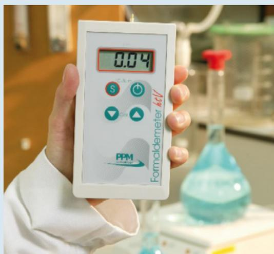
Das Formaldemeter htV ist als portables Messgerät oder fortlaufend überwachender Datenlogger einsetzbar.
