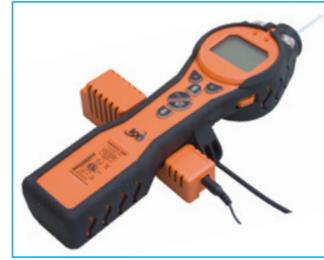
Leistungsstarkes Ladegerät bietet kurze Akku-Ladezeiten: Bei nur 6,5 Stunden Ladezeit ermöglichen die **langlebigen Li-Ion Akkus** eine Einsatzdauer von bis zu 30 Stunden. Und eine 8-stündige Einsatzdauer ist bereits nach einer kurzen Ladezeit von lediglich 1,5 Stunden möglich.
