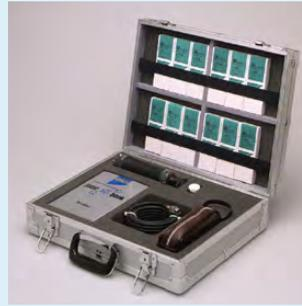
Einsatzkoffer zur Bestimmung unbekannter Gase anhand Messschema TG1 mit Polytec I.
